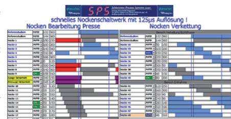
am Tischantrieb. Als Besonderheit können alle Nocken mit Sicherheitsbereichen (hier rot dargestellt) versehen werden. Diese vom normalen Maschinenführer nicht änderbaren Grenzwerte dienen zum Schutz der Maschine.
